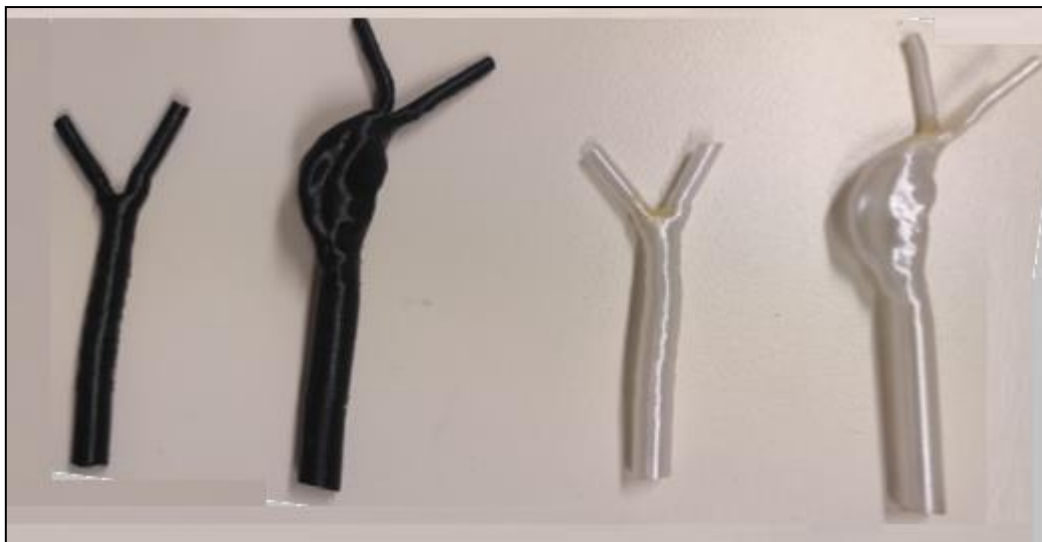
Εικόνα 28: Ζευγάρια δοκιμίων (υγειούς - παθολογικού) κατασκευασμένα από διαφορετικό υλικό.
