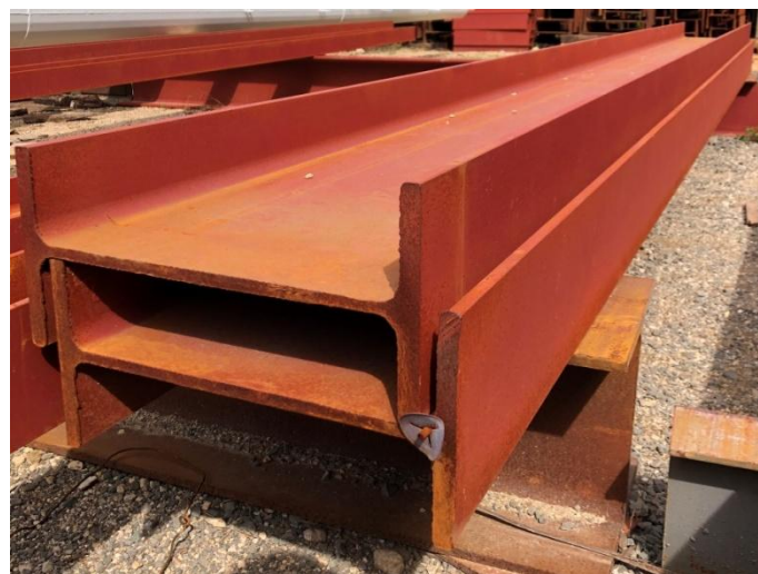
Εικόνα 2. Αμμοβολισμένα και βαμμένα υψίκορμα δοκάρια
