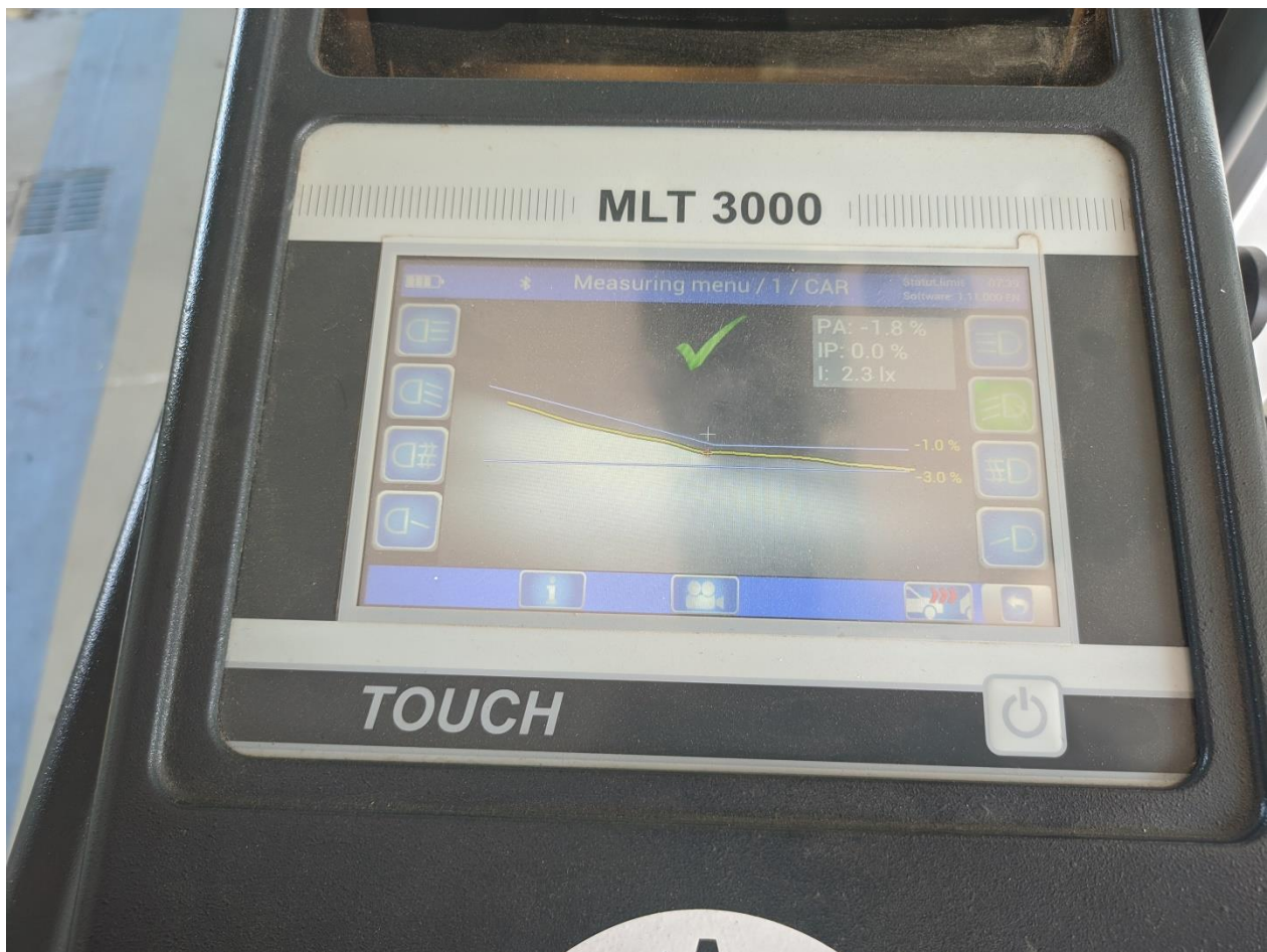
Εικόνα 6: Ψηφιακός πίνακας Φωτόμετρου
