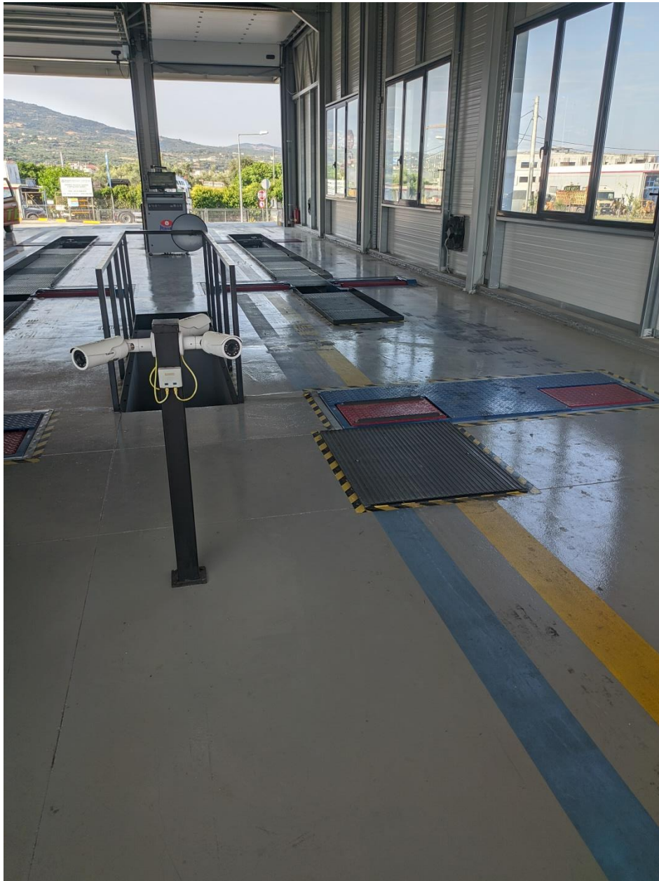
Εικόνα 3: Συγκλισιόμετρο και σταθερές κάμερες μηχανογραφικού.
