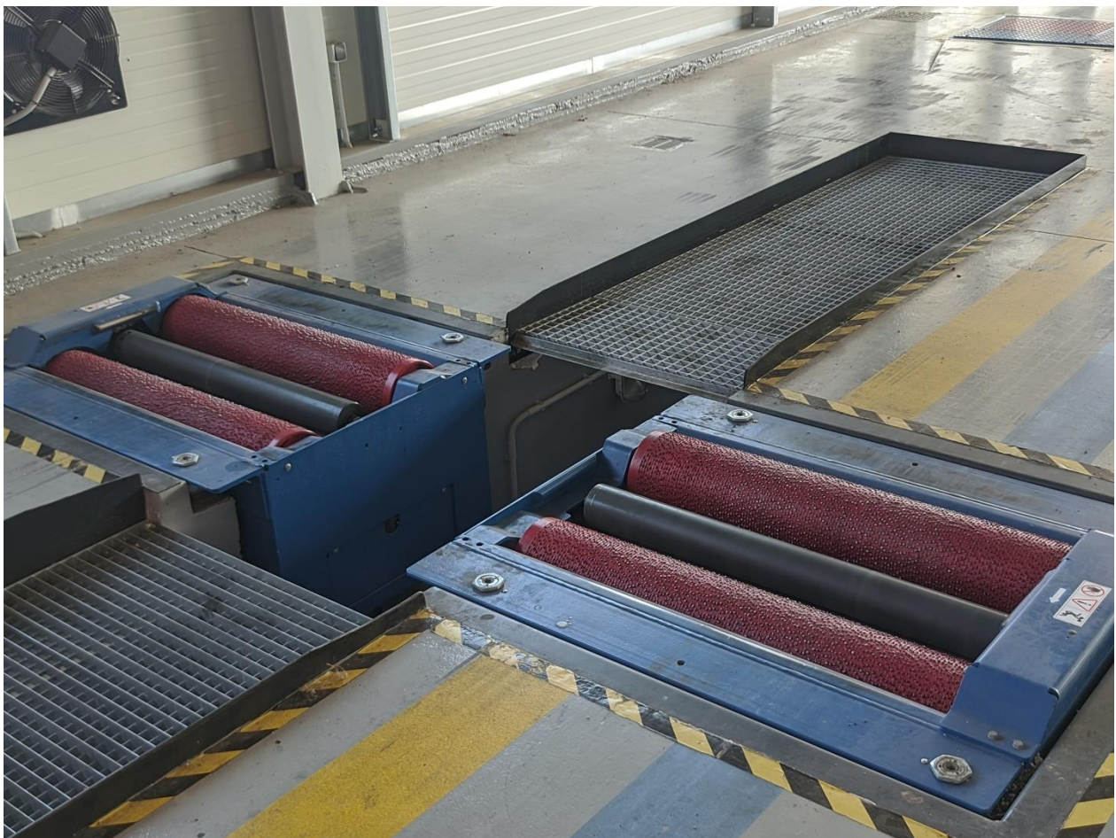
Εικόνα 4: Φρενόμετρο Αυτόματης Γραμμής Ελέγχου
