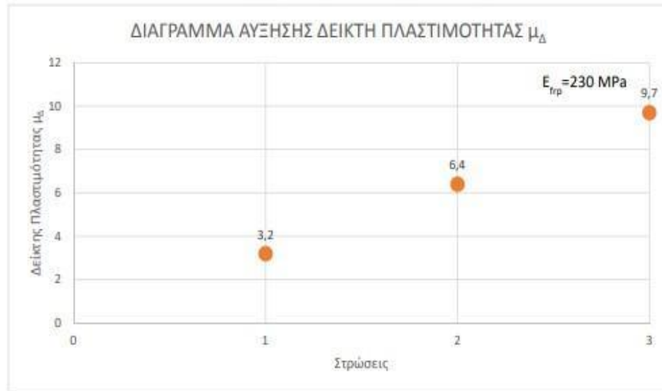
Σχήμα 4- 13: Διάγραμμα αύξησης δείκτη πλαστιμότητας \mu_{\Delta}
