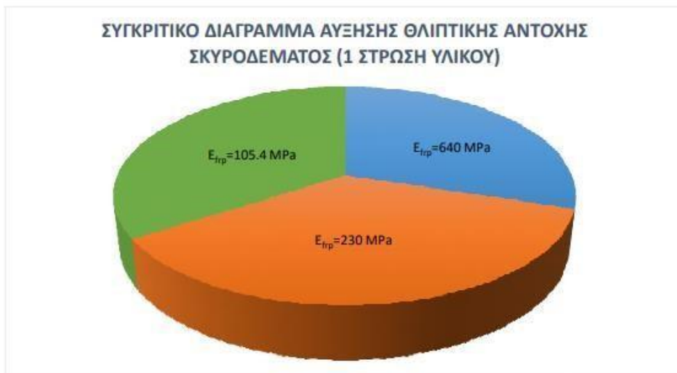
Σχήμα 4- 10: Συγκριτικό διάγραμμα αύξησης θλιπτικής αντοχής σκυροδέματος για μία στρώση υλικού
