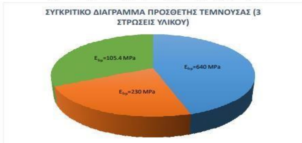
Σχήμα 4- 6: Συγκριτικό διάγραμμα πρόσθετης τέμνουσας για τρεις στρώσεις υλικού
