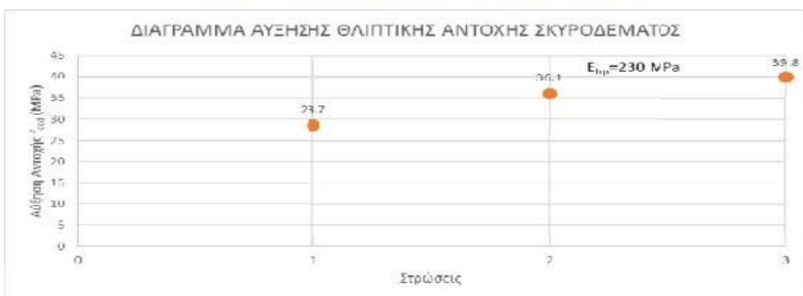
Σχήμα 4- 7: Διάγραμμα αύξησης θλιπτικής αντοχής σκυροδέματος
