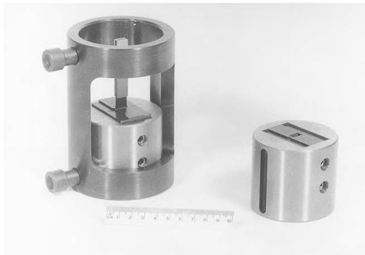
Εικόνα 4.7. British Aerospace compression jig, Έκδοχή της μεθόδου Celanese [37].
