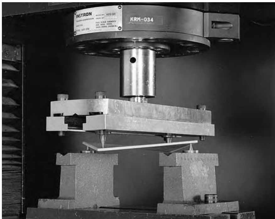
Εικόνα 3.9: Μέθοδος διάτμησης πλάκας [28].
