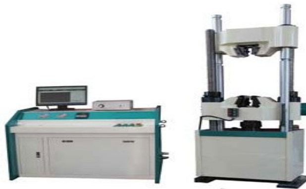
Εικόνα 2.6: Σέρβο-υδραυλική μηχανή συνδεδεμένη με υπολογιστή για συλλογή δεδομένων για εφελκυστηκές δοκιμές για δοκίμια συνθέτων υλικών [15].
