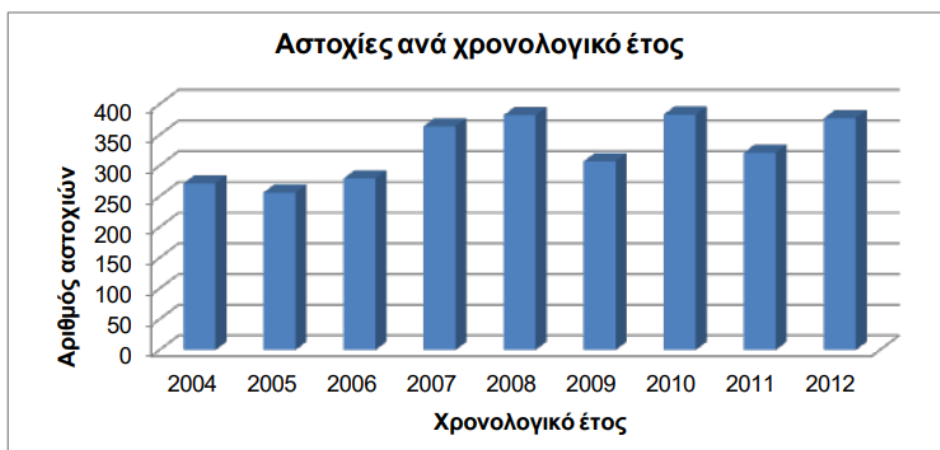
Σχήμα 6.15 : Αριθμός αστοχιών που συνέβησαν κατά τη διάρκεια της οκταετίας 2004 - 2012 σε δίκτυα Μ.Τ. με περισσότερους από έναν υποσταθμούς διανομής, κατηγοριοποιημένες κατ' έτος. [64]
