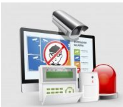
Εικόνα (1): Απεικόνιση συστήματος ασφαλείας με συναγερμό, κάμερα, οθόνη, πληκτρολόγιο και αισθητήρες.
