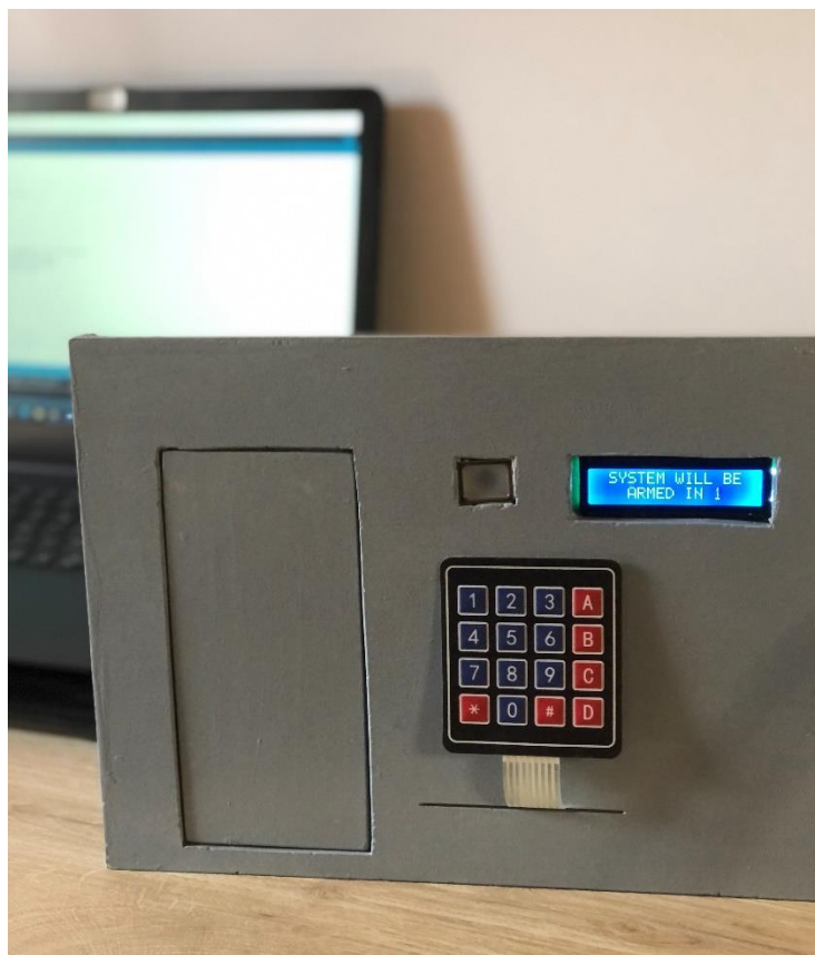
Εικόνα (42): Η κατάσταση του συστήματος όταν πατηθεί το A. 10sec μέχρι το σύστημα να γίνει Armed.
