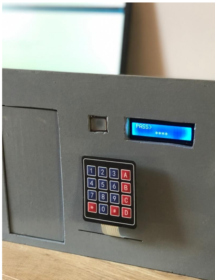
Εικόνα (35): Αναμονή για κωδικό ή δακτυλικό αποτύπωμα.
