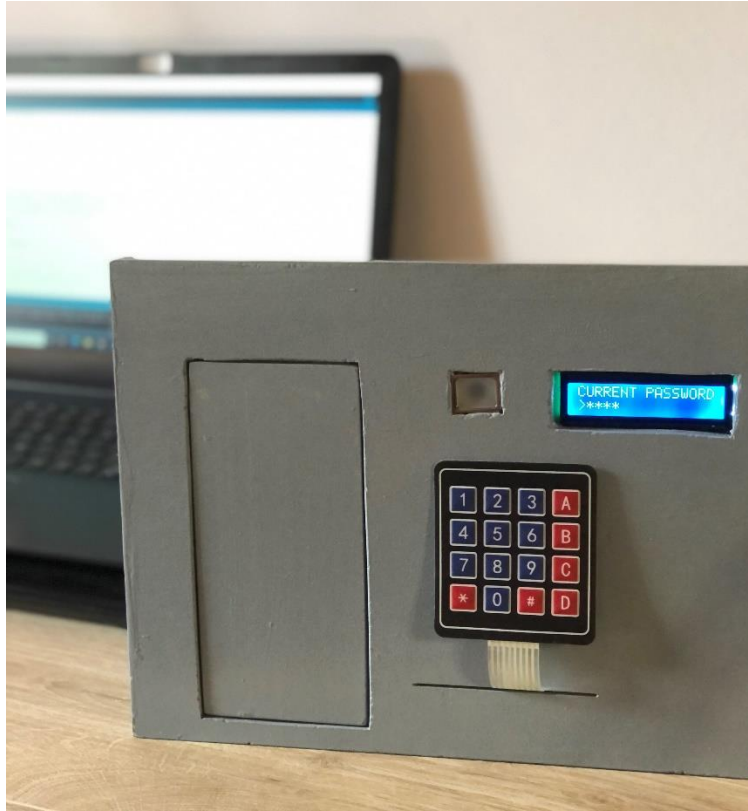
Εικόνα (43): Η κατάσταση του συστήματος όταν πατηθεί το B. Ζητείται ο υπάρχον κωδικός.
