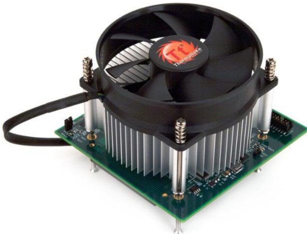
Figure 30. Συσκευή για FPGA εξόρυξη με ενσωματωμένη ψύξη
