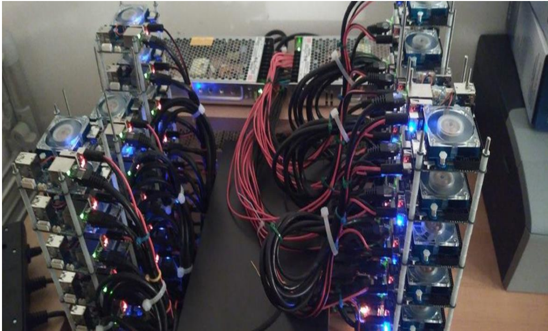
Figure 27. CPU mining για τα κρυπτονομίσματα Verium και Vericoïn
