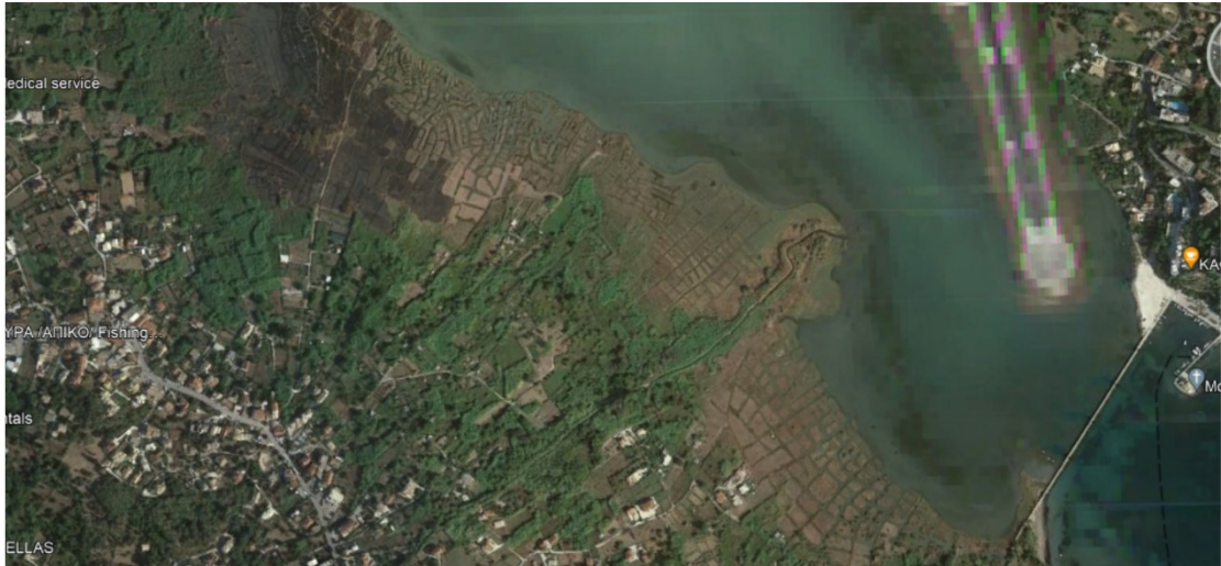
Εικόνα 19 Διαμορφωμένα κανάλια με σκοπό τη αποξήρανση της λιμνοθάλασσας, που έγιναν στην περίοδο της Αγγλοκρατίας στις νοτιοδυτικές όχθες της (από Googleearthpro, 10/4/2022).
