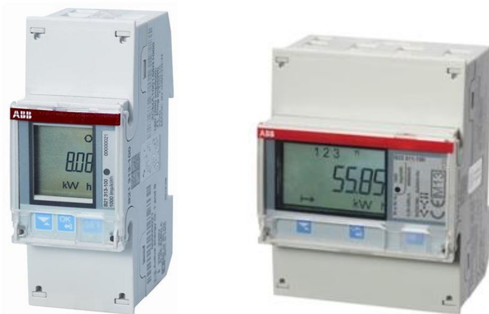
Εικόνα 3-7 Ενδεικτικός τύπος: Μονοφασικός ηλεκτρονικός μετρητής ενέργειας: B21 (άμεσης μέτρησης έως 65A), Τριφασικός ηλεκτρονικός μετρητής ενέργειας: B23 (άμεσης μέτρησης έως 65A) & B24 (έμμεσης μέτρησης μέσω M/Σ)
