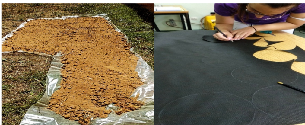
Εικόνα 20: Η ξήρανση του χώματος στο νάιλον Εικόνα 21: Η κοπή των γεωφασμάτων
