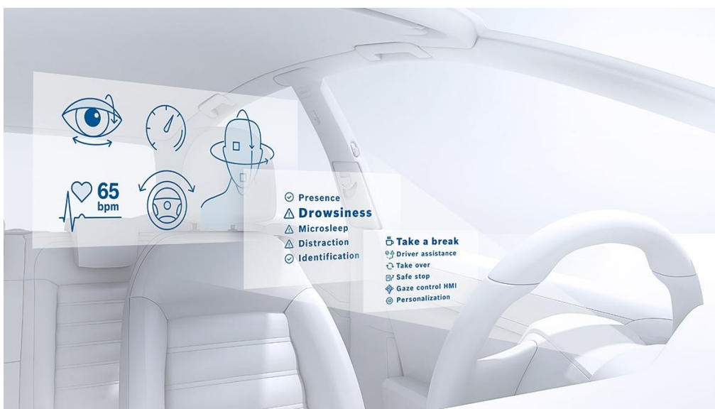
Εικόνα 42: Τρόποι μέτρησης της προσοχής του οδηγού.
