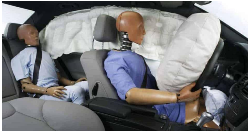
Εικόνα 1: Άνοιγμα αερόσακου σε crash test.
