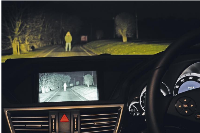
Εικόνα 37: Παράδειγμα λειτουργίας συστήματος νυχτερινής όρασης.
