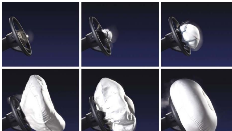
Εικόνα 8: Σταδιακό άνοιγμα αερόσακου.
