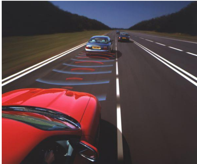
Εικόνα 13: Παράδειγμα λειτουργίας του Adaptive Cruise Control.
