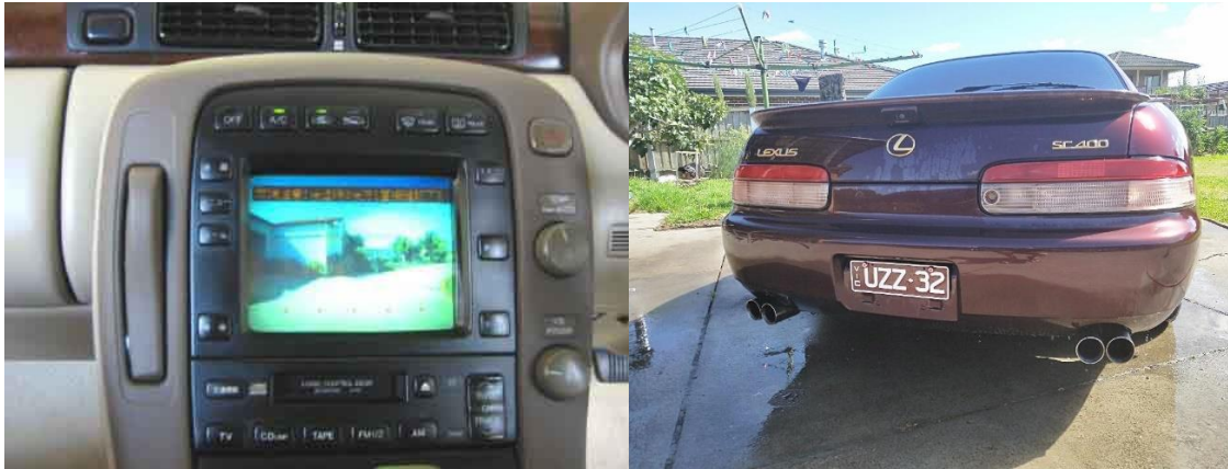
Εικόνα 11: Μία από τις πρώτες κάμερες οπισθοπορείας σε λειτουργία.
