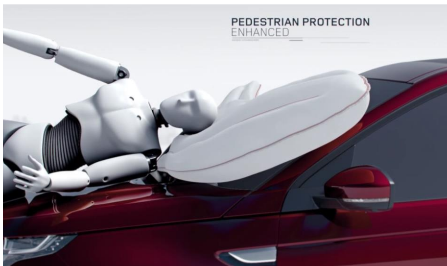
Εικόνα 16: Άνοιγμα αερόσακου για πεζούς.
