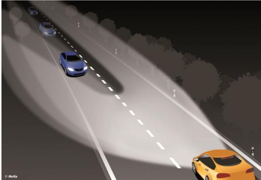
Εικόνα 33: Παράδειγμα αποφυγής προσωρινής τύφλωσης άλλων οδηγών.
