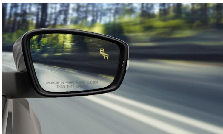
Εικόνα 38: Σήμανση ανίχνευσης οχήματος στην περιοχή του τυφλού σημείου.
