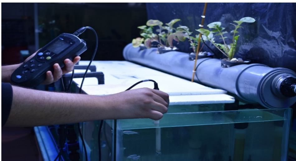
Εικόνα 10. Φυσικοχημικές μετρήσεις νερού με φορητό ηλεκτρονικό όργανο μέτρησης (HACH HQ 40 D) (Πηγή: Προσωπικό αρχείο)
