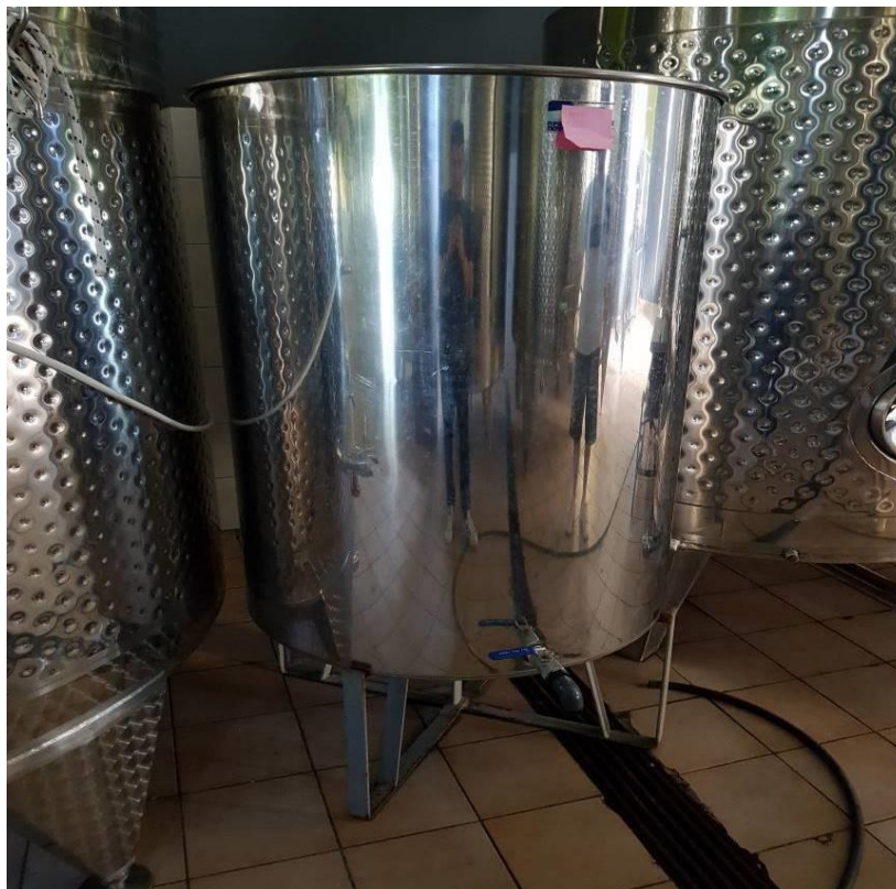
Εικόνα 3-9: Δεξαμενή αποθήκευσης κρασιού 0,7tn
