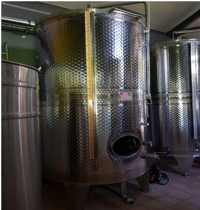
Εικόνα 3-8: Δεξαμενή αποθήκευσης κρασιού 5tn
