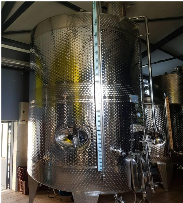
Εικόνα 3-5: Δεξαμενή αποθήκευσης κρασιού 10tn
