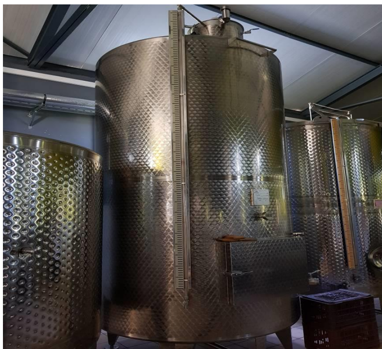
Εικόνα 3-6: Δεξαμενή αποθήκευσης κρασιού 8tn
