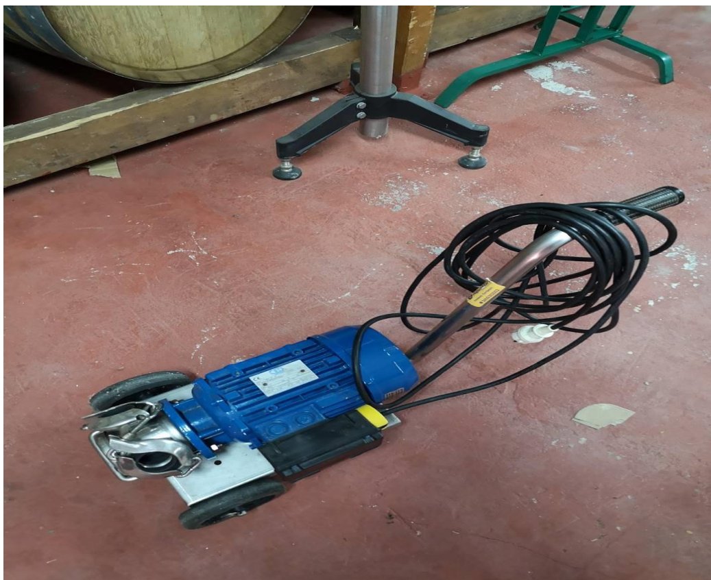
Εικόνα 3-13: Αντλία μεταφοράς Ceg
