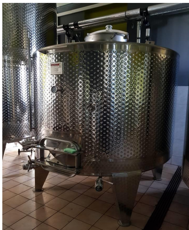
Εικόνα 3-4: Δεξαμενή αποθήκευσης κρασιού 2tn
