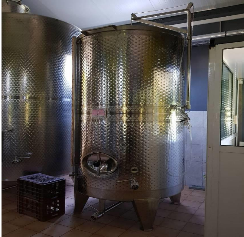
Εικόνα 3-7: Δεξαμενή αποθήκευσης κρασιού 4tn
