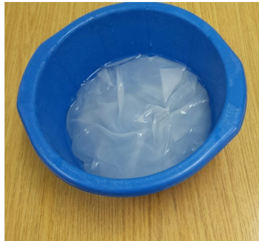
Εικόνα 5.21: Διαβροχή μεμβρανών και υφασμάτων με απιονισμένο νερό
