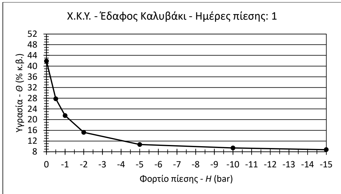
Σχήμα 6. 21: Χαρακτηριστική καμπύλη υγρασίας κατά βάρος, για το δείγμα Καλυβάκι μετά από μία ημέρα πίεσης
