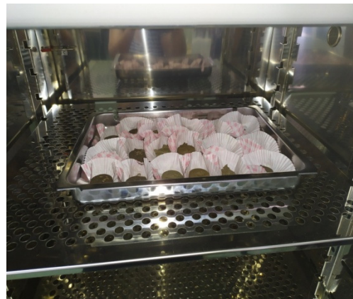
Εικόνα 5.34: Τοποθέτηση δειγμάτων στο φούρνο ξήρασης στους 105° C.
