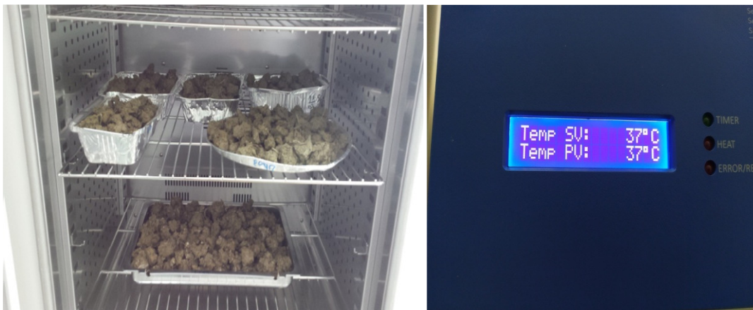
Εικόνα 5.17: Εισαγωγή των δειγμάτων στο πυριαντήριο στους 37° C .
