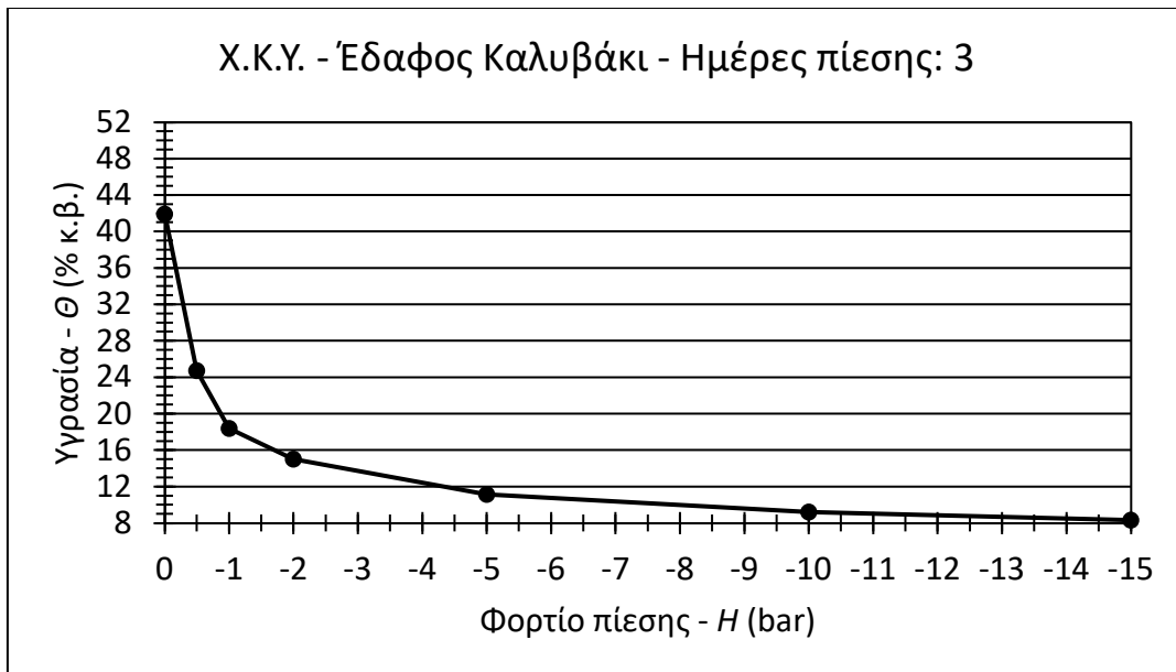
Σχήμα 6. 23: Χαρακτηριστική καμπύλη υγρασίας κατά βάρος, για το δείγμα Καλυβάκι μετά από τρεις ημέρες πίεσης
