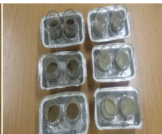
Εικόνα 5.29: Κορεσμός των 6 εδαφών στη 0 bar για 5 ημέρες
