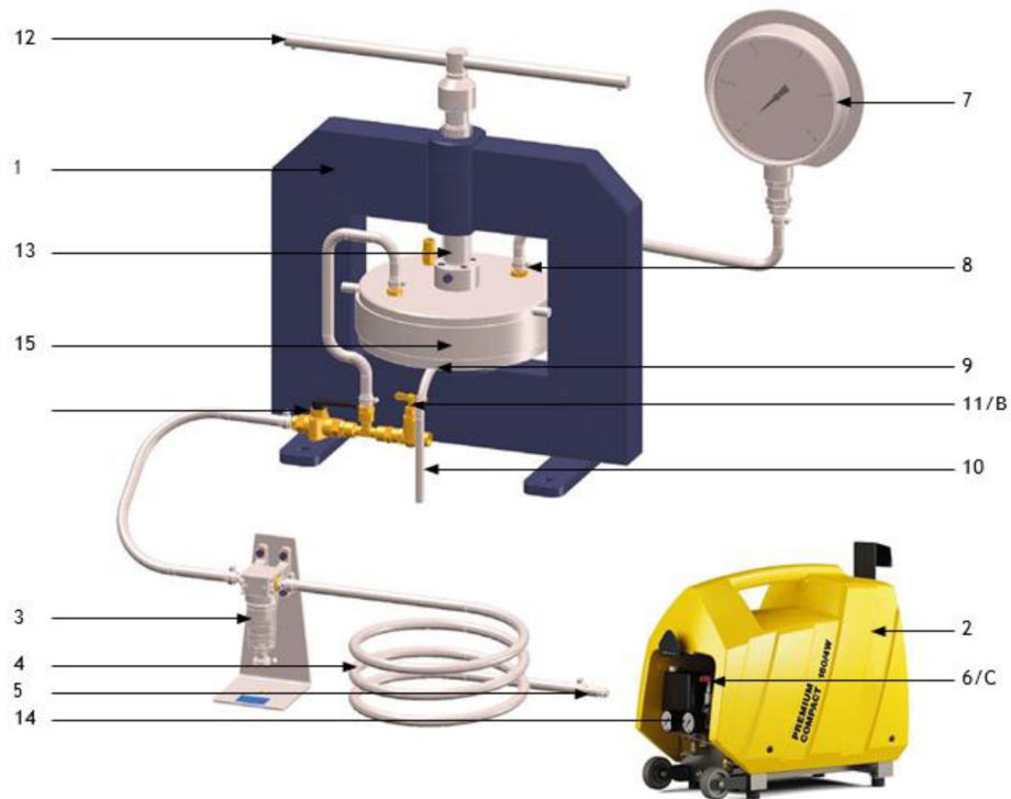
Εικόνα 5.2 Συσκευή Pressure Membrane Apparatus με αριθμημένα εξαρτήματα.
