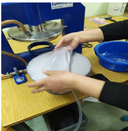
Εικόνα 5.24: Τα 2 φύλλα υφάσματος τοποθετούνται και αφαιρούνται οι φυσαλίδες αέρα.
