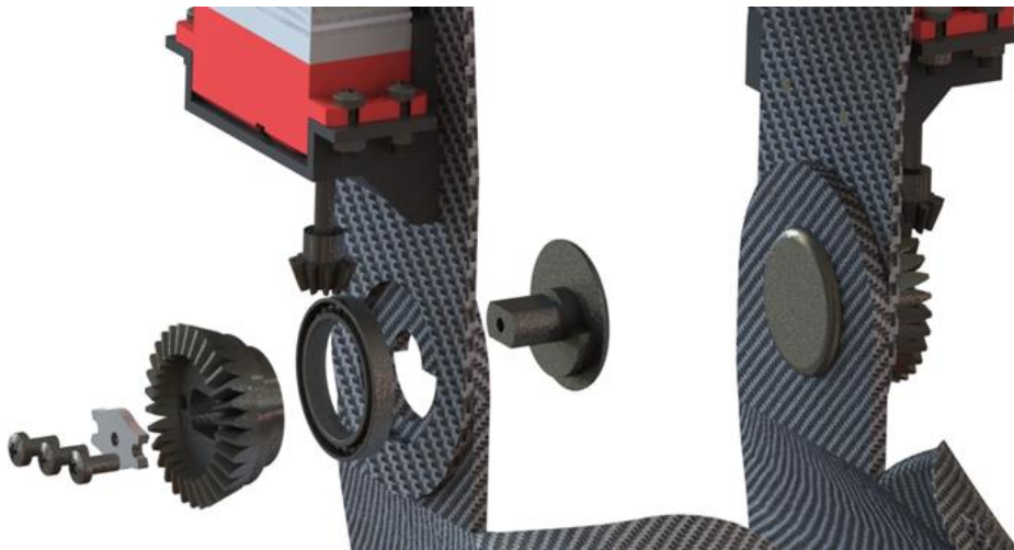
Εικόνα 27 Θέση εδράνου κύλισης στον κνημοποδικό κηδεμόνα ExoGaitOR
