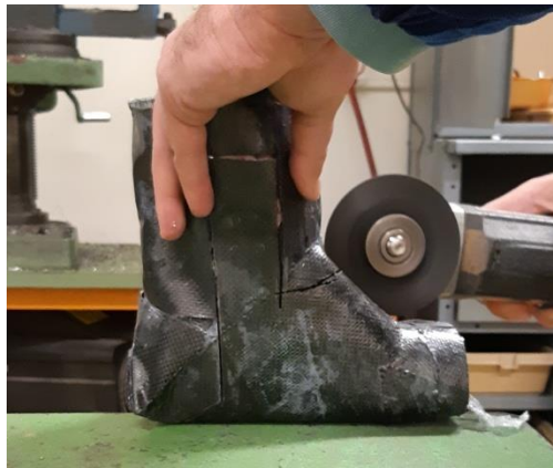
ζ) Κοπή με ηλεκτρικό τροχό
