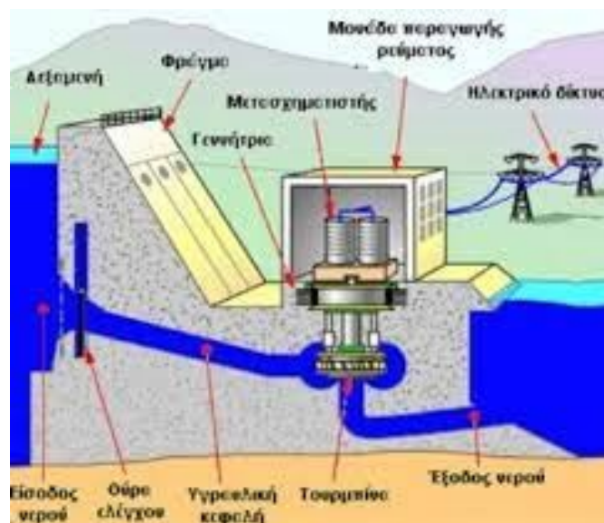
Εικόνα 2.2: Μέρη Υδροηλεκτρικού Σταθμού
