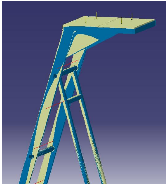
Εικόνα 3. 44: Παραμόρφωση της κλίμακας λόγω φορτίων
