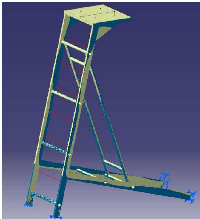
Εικόνα 3. 43: Παραμόρφωση της κλίμακας λόγω φορτίων
