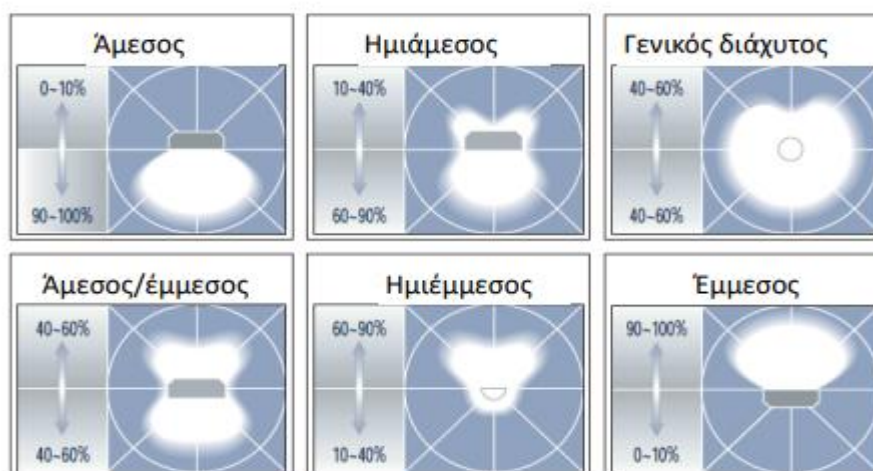
Εικόνα 1.21 Φωτιστικά εσωτερικού χώρου ανάλογα την κατανομή φωτεινής ροής
