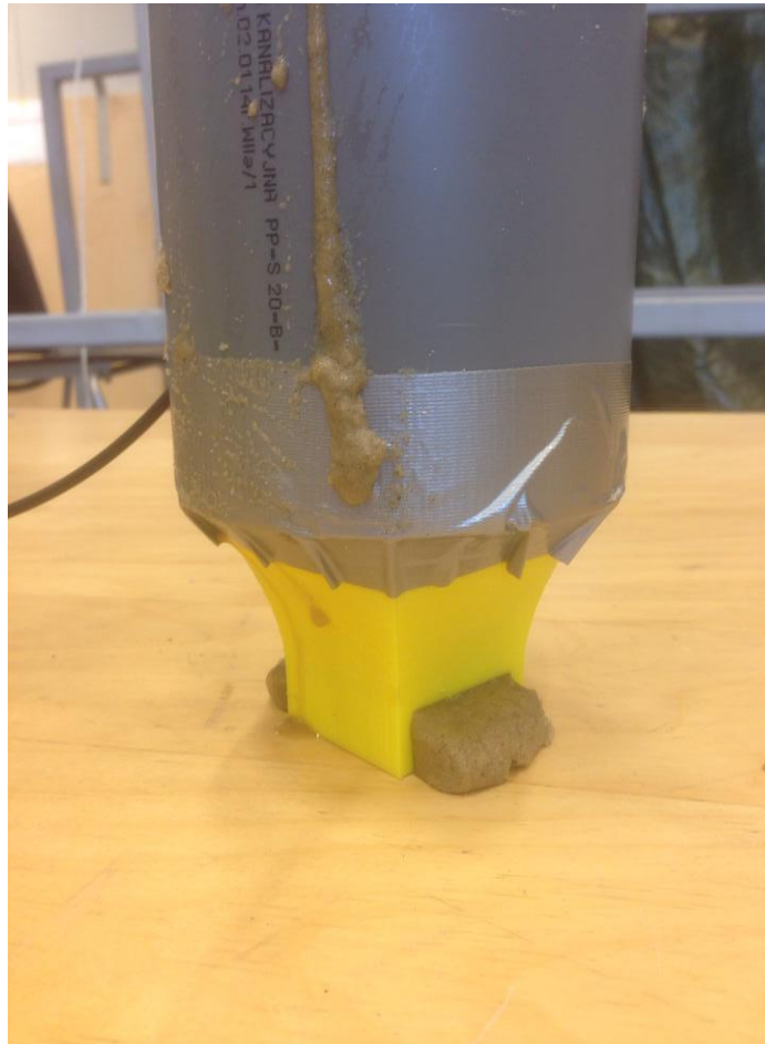
Εικόνα 4.8 Αποτελέσματα της δοκιμής με τον κωνικό πυθμένα.
