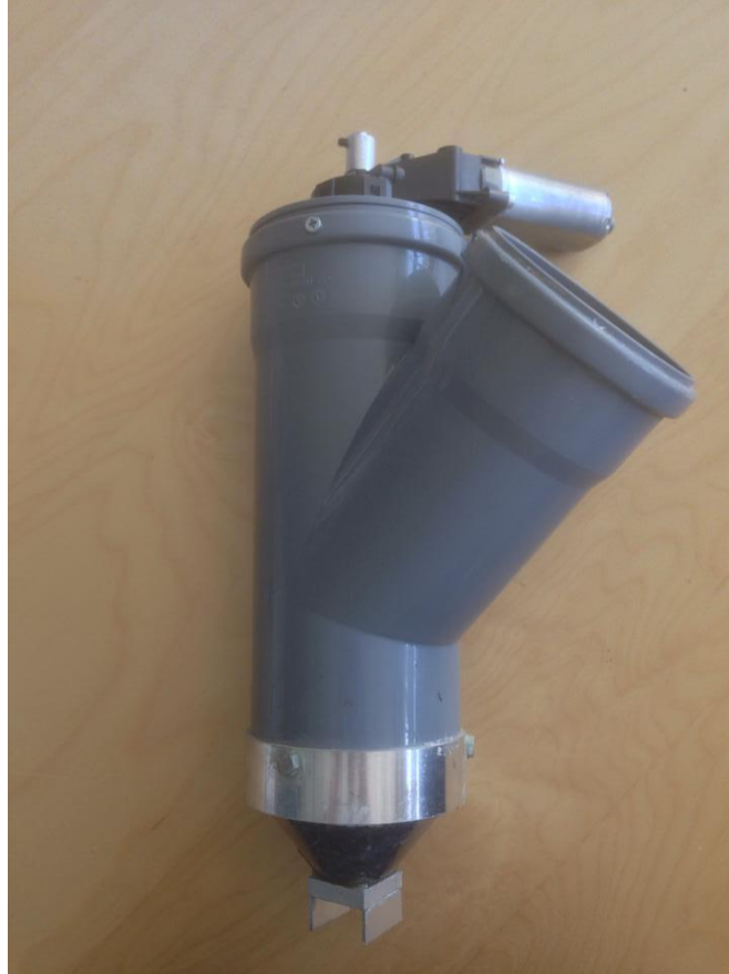
Εικόνα 4.13 Εξωθητήρας με τον νέο κινητήρα και τον μεταλλικό πυθμένα.
