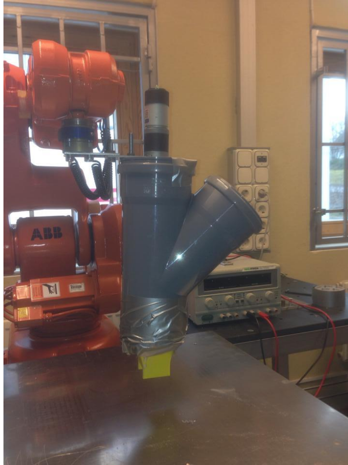
Εικόνα 4.11 Εξωθητήρας με το νέο σωλήνα σχήματος γ.
