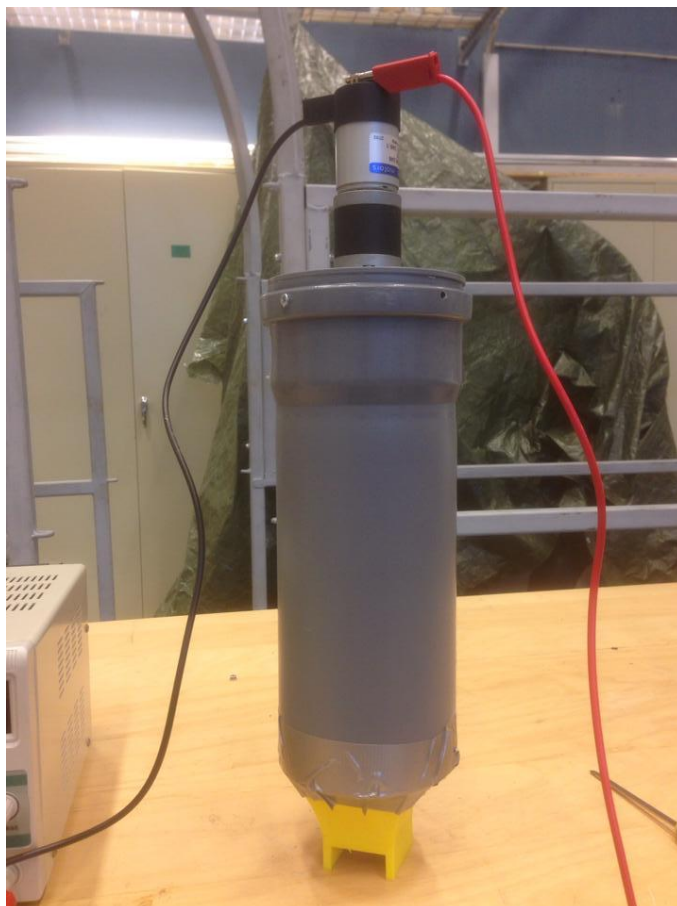
Εικόνα 4.7. Εξωθητήρας με το νέο κωνικό πυθμένα.
