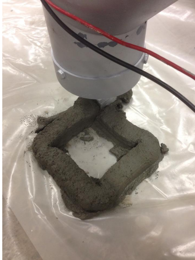
Εικόνα 4.25 Τετραγωνική κατασκευή από τον εκτυπωτή.
