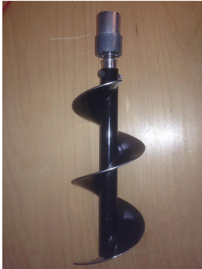
Εικόνα 4.2 Αρίδα συζευγμένη στον ηλεκτροκινητήρα.
