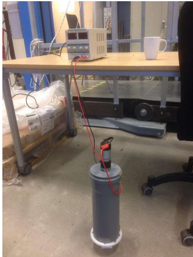
Εικόνα 4.4 Νέος ισχυρότερος κινητήρας τοποθετημένος στον εξωθητήρα.
