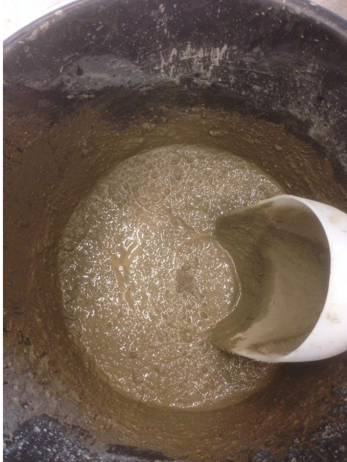
Εικόνα 4.16 Τυπικό σκυρόδεμα με περισσότερο νερό.
