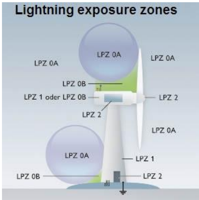
Εικόνα 4-1 Τυπική εφαρμογή της μεθόδου κυλιόμενης σφαίρας
