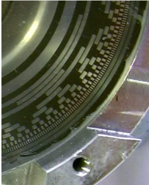
Εικόνα 5-1 Κωδικοποιητής απόλυτης θέσης που χρησιμοποιεί κώδικα Gray ( https://acomelectronics.com/forum/viewtopic.php?t=130 )
