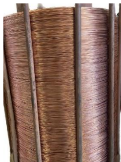
Εικόνα 1.5 Σύρμα αγωγού και οπλισμού
