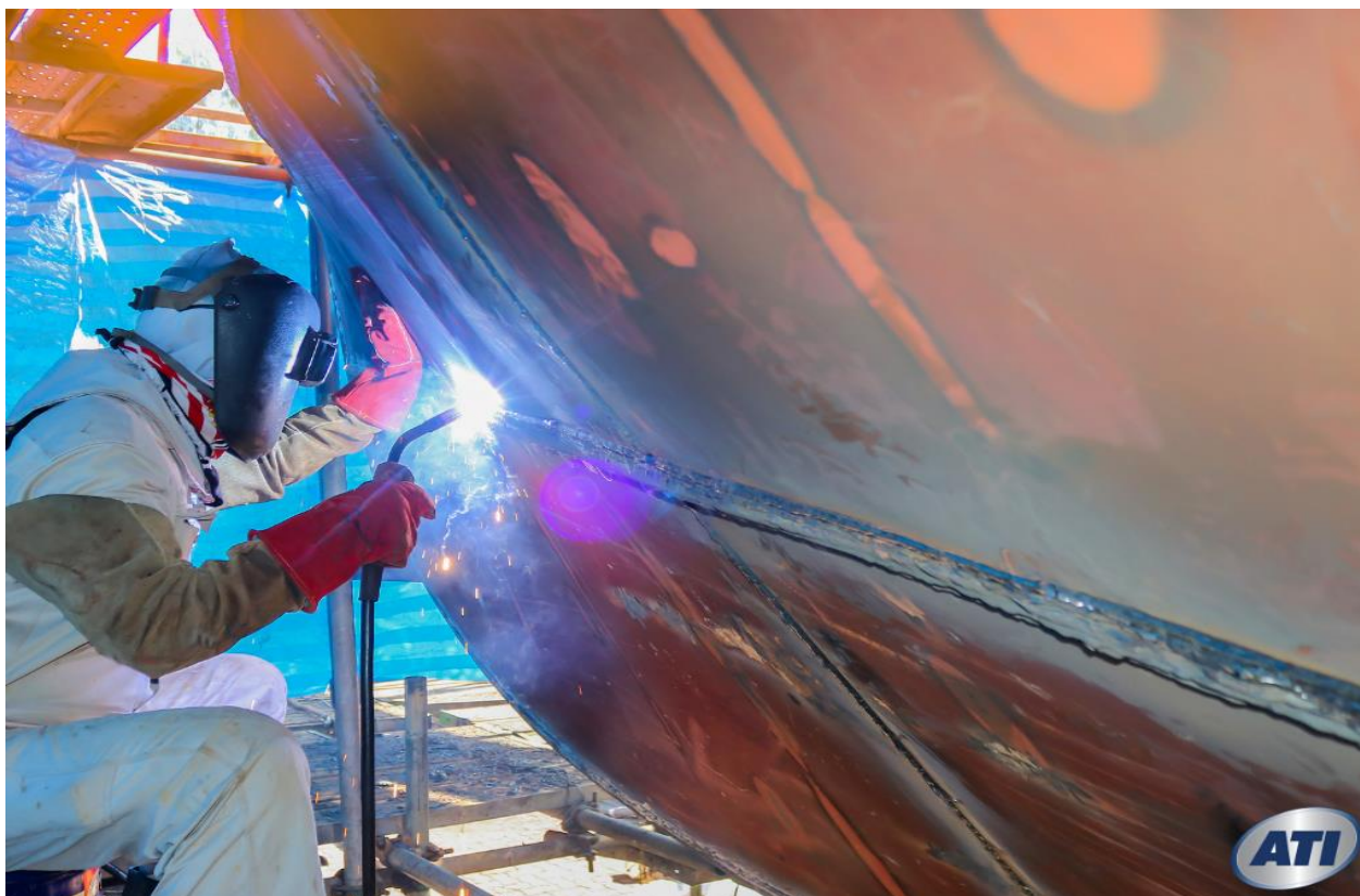
Εικόνα 2.9 : Ηλεκτροσυγκόλληση πλοίου ( https://auto.edu/blog/what-is-maritime-welding-important )
