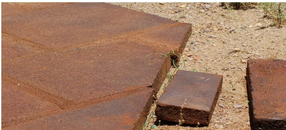
Εικόνα 18: Νέο οικοδομικό υλικό από χάλυβα - Ferrock . Πηγή 2021: https://buildabroad.org/2016/09/27/ferrock/
