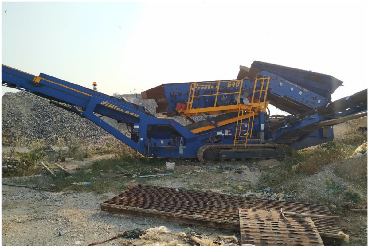
Εικόνα 15: Μηχάνημα προδιαλογής-κόσκινο Fintec 640. (Καμελίδης, 2020)
