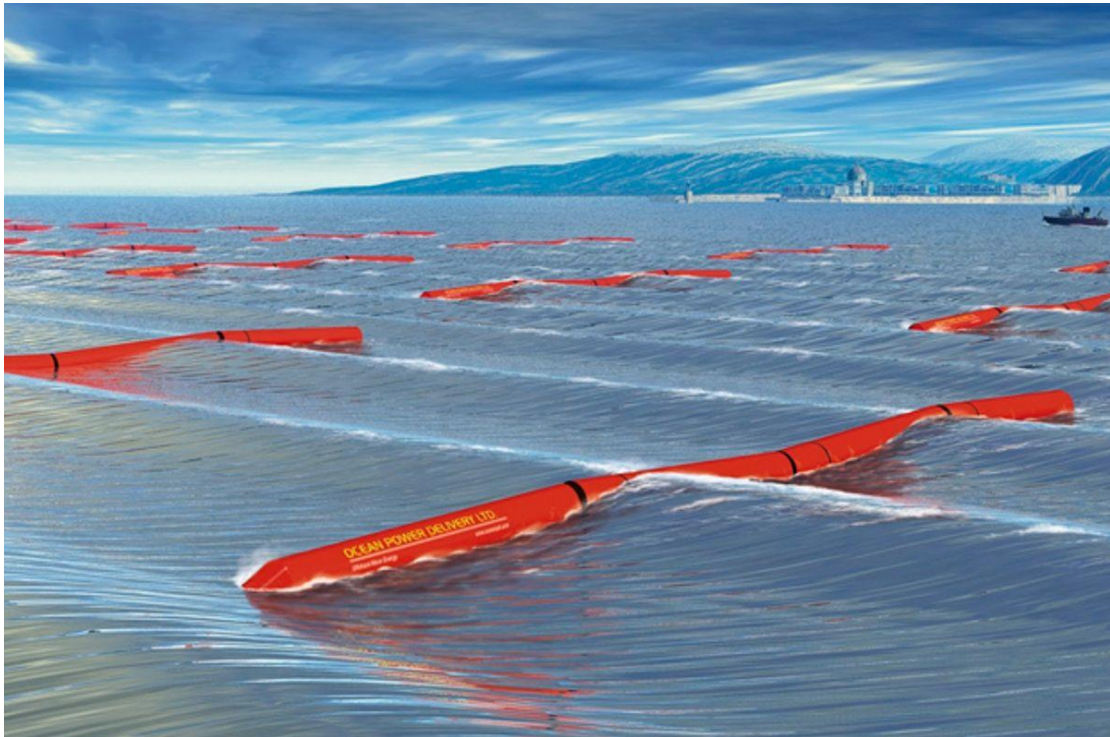
Εικόνα 2.11 Ένα "κυματικό αγρόκτημα" 30 MegaWatt μετατροπέων ενέργειας κυμάτων Pelamis (Business Wire)( https://www.salon.com/2016/08/27/is-blue-the-new-green-wave-power-could-revolutionize-the-renewable-energy-game/ )
