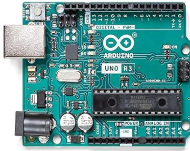
Εικόνα 4.1 Αναπτυξιακή πλακέτα Arduino Uno Arduino Uno Rev3 — Arduino Official Store
