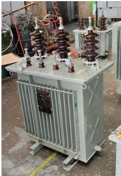
ΕΙΚΟΝΑ ΜΕΤΑΣΧΗΜΑΤΙΣΤΗ 20kV/400V
