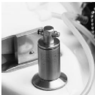
Εικ.19: ο ψεκαστήρας πρέπει να γυρίζει ελεύθερα
