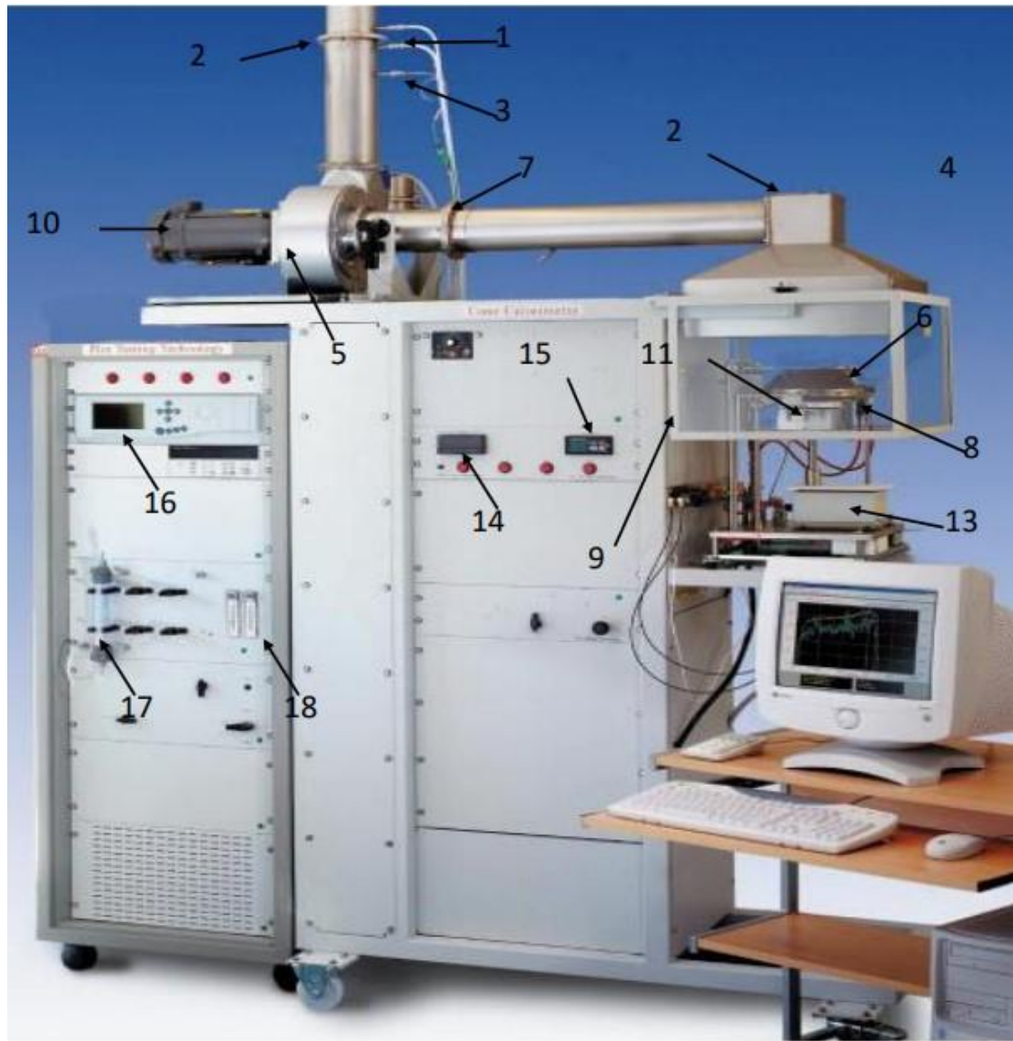
Εικόνα 3.1: Η συσκευή Θερμιδόμετρου Κώνου με τα περιφερειακά της (FTT).
