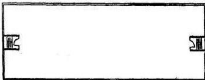
Εικόνα 6: Οδεύσεις διαφύγεις σε βιομηχανίες και αποθήκες α) δύο διαδρομές απόδρασης (Z.1) και β) πραγματική και άμεση απόσταση (Z.2) [Πηγή: ΚΤΙΚ, ΚΕΦΑΛΑΙΟ Β': ΕΙΔΙΚΕΣ ΔΙΑΤΑΞΕΙΣ – Άρθρο 9: Βιομηχανία – Βιοτεχνία]
