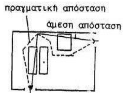
Εικόνα 6: Οδεύσεις διαφύγεις σε βιομηχανίες και αποθήκες α) δύο διαδρομές απόδρασης (Z.1) και β) πραγματική και άμεση απόσταση (Z.2) [Πηγή: ΚΤΙΚ, ΚΕΦΑΛΑΙΟ Β': ΕΙΔΙΚΕΣ ΔΙΑΤΑΞΕΙΣ – Άρθρο 9: Βιομηχανία – Βιοτεχνία]
