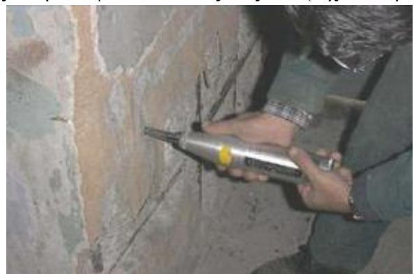
Εικόνα 3.7 Η μέθοδος του κρουσιμέτρου.
