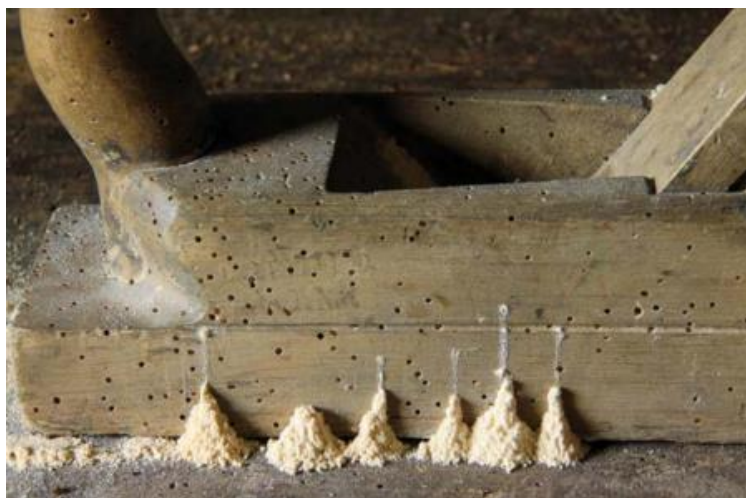
Εικόνα 2.16: Οπές από έντομα σε ξύλινες επιφάνειες.
