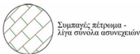
Σχήμα 1.9: Συμπαγές πέτρωμα διατεμνόμενο από περιορισμένο αριθμό συστημάτων ασυνεχειών. (Νομικός Π. , 2015).
