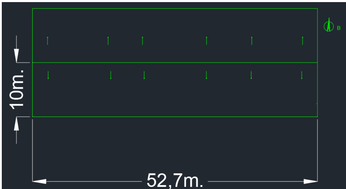
3.2 Κάτοψη εκμεταλλεύσιμης επιφάνειας βιομηχανικής στέγης.
