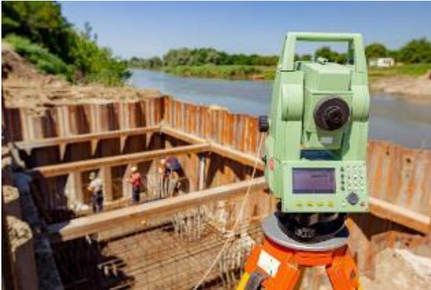
Εικόνα 55 γεωδαιτικός σταθμός (total station) που χρησιμοποιείται σε εργοτάξια για ακριβείς μετρήσει
