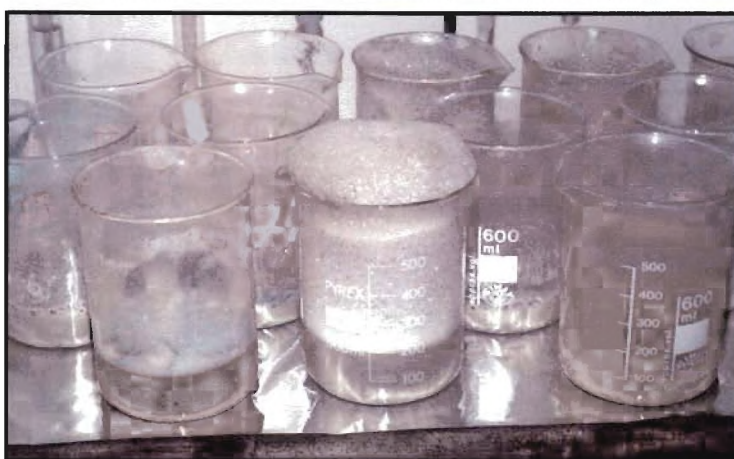
Εικόνα 12. Δείγματα κατά την οξείδωση του οργανικού υλικού τους. Η δημιουργία αφρού οφείλεται στην αντίδραση του C_{org} και του H_2O_2 .
