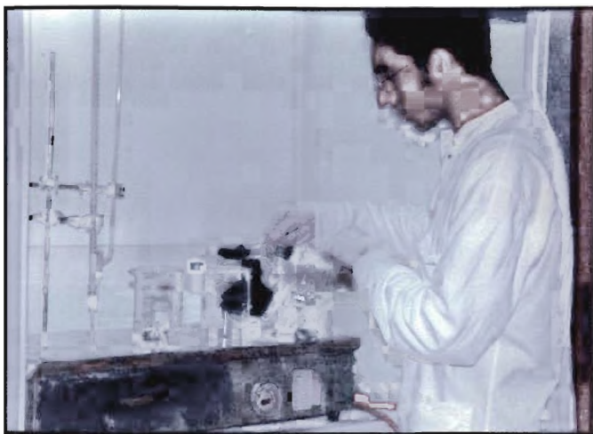
Εικόνα 9. Τοποθέτηση δείγματος σε ποτήρι ζέσεως για οξείδωση οργανικού υλικού.
