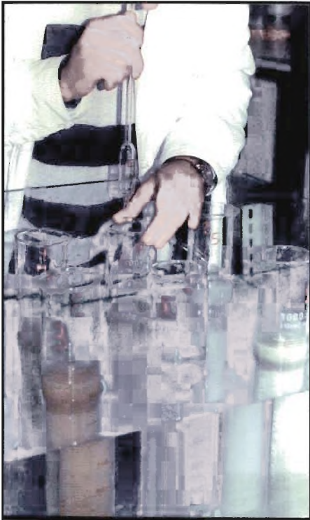
Εικόνα 20. Λήψη μέτρησης με την πιπέτα όγκου 20ml.
