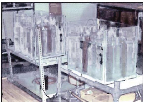
Εικόνα 18. Λουτρά γεμισμένα με νερό θερμοκρασίας 26°C, στα οποία είναι τοποθετημένοι οι 16 σωλήνες 1lt με τα εναιωρήματα νερού - ιζήματος, για την κοκκομετρία με τη μέθοδο της πιπέτας.
