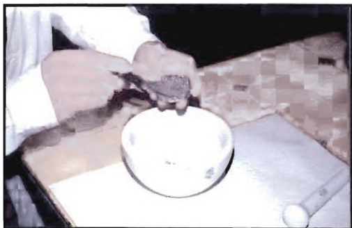
Εικόνα 28. Τοποθέτηση ξηραμένου δείγματος στο γουδί από αχάτι για κονιοποίηση.
