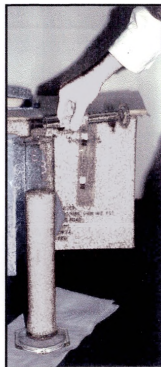
Εικόνα 15. Υγρό κοσκίνισμα. Τυχόν συσσωματώματα διαλύονται με ελαφρά πίεση των δακτύλων.
