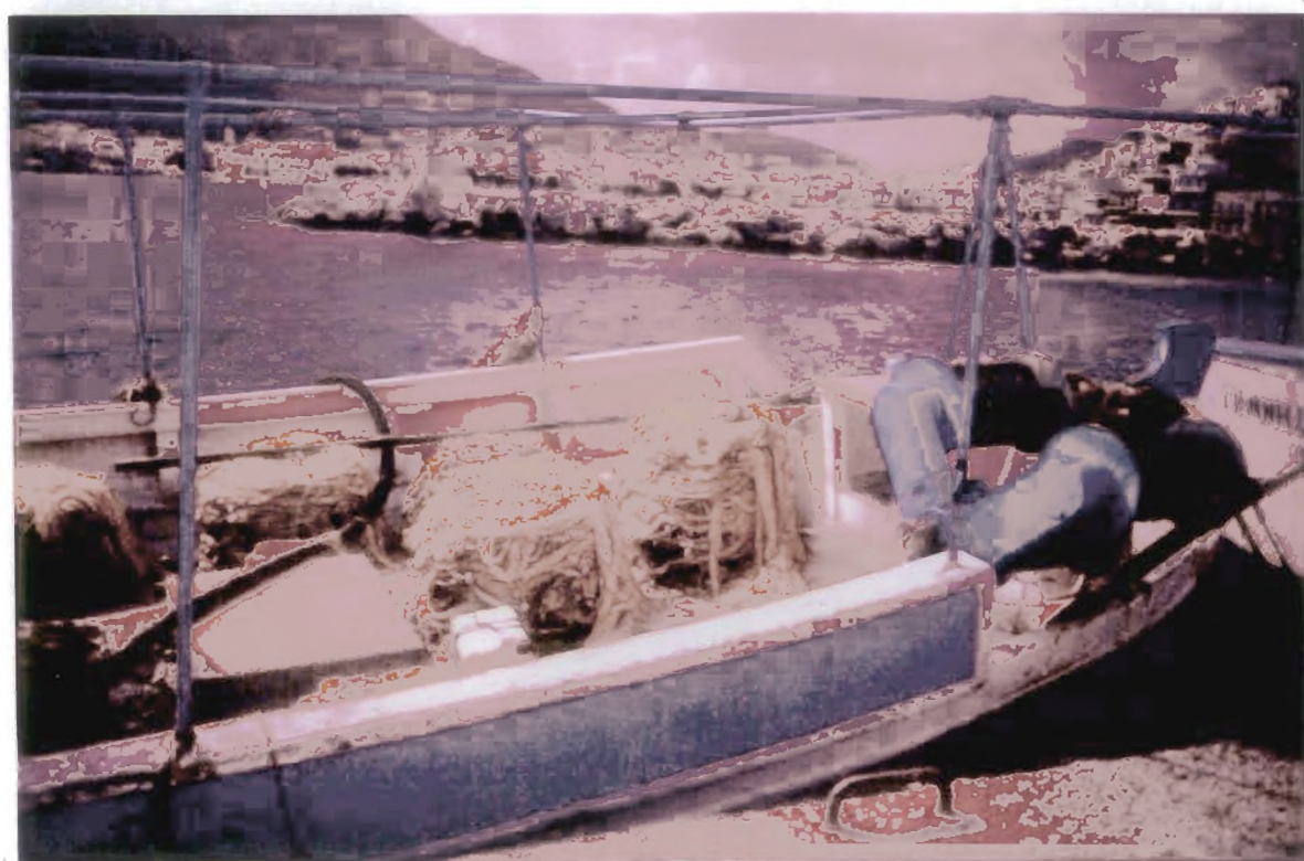
Φωτ. 6 Διχτυάρικα με δίχτυα και τα τύμπανα ανέλκυσης.
