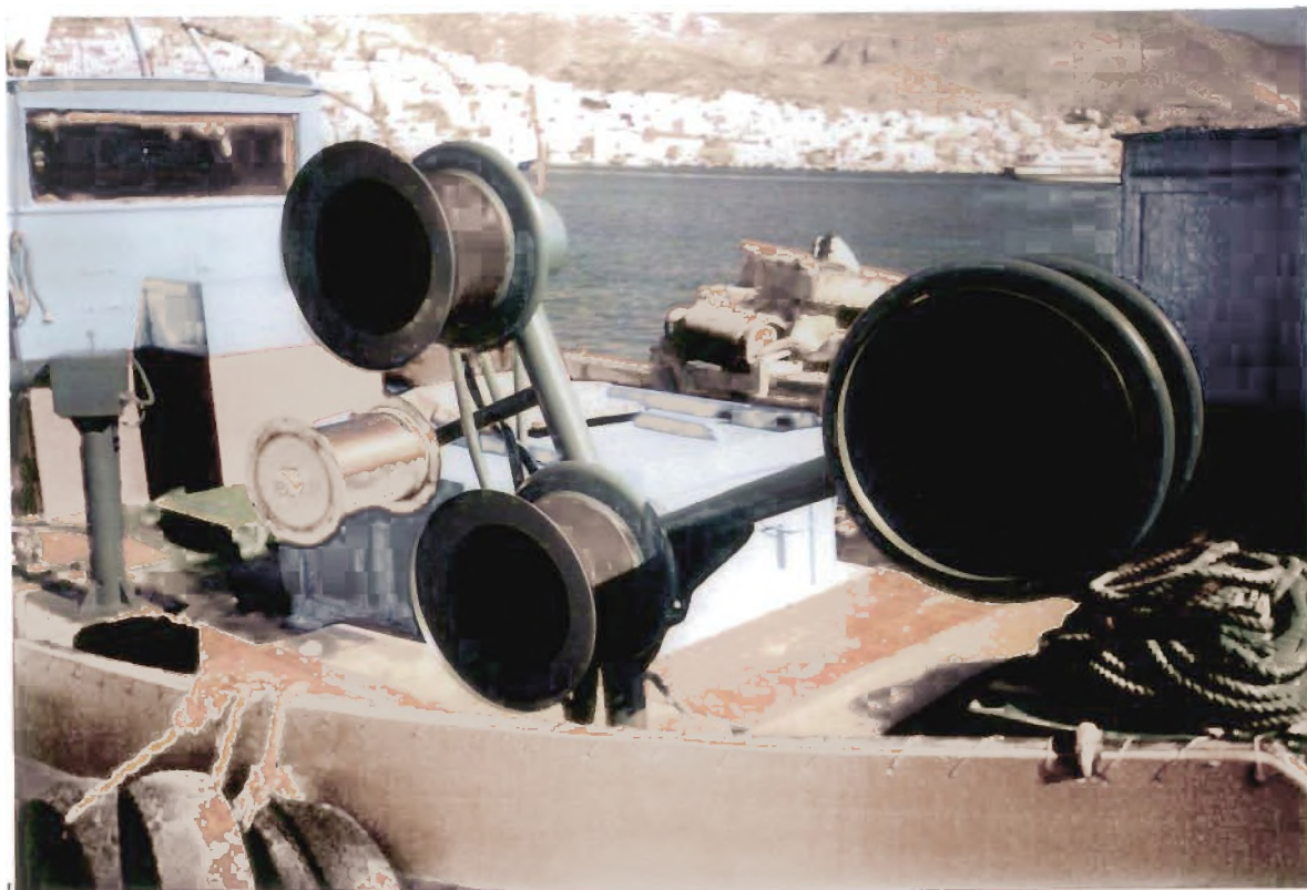
Φωτ. 7 Μηχανοκίνητο βίντσι για ανέλκυση(διχτυάρικου).
