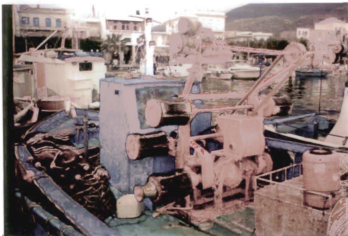
Φωτ. 5 Μηχανοκίνητο βίντσι της τράτας.
