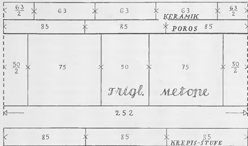
Abb. 222. Schema der Masse des Gebälks des Tempels A. — E. D.
