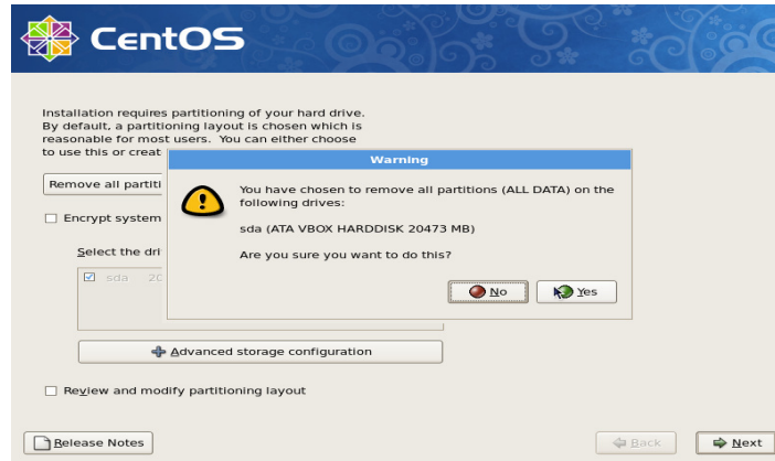
Εικόνα 5.9 Παράθυρο επιβεβαίωσης των επιλογών σχετικά με τον σκληρό δίσκο όπου θα γίνει εγκατάσταση.
