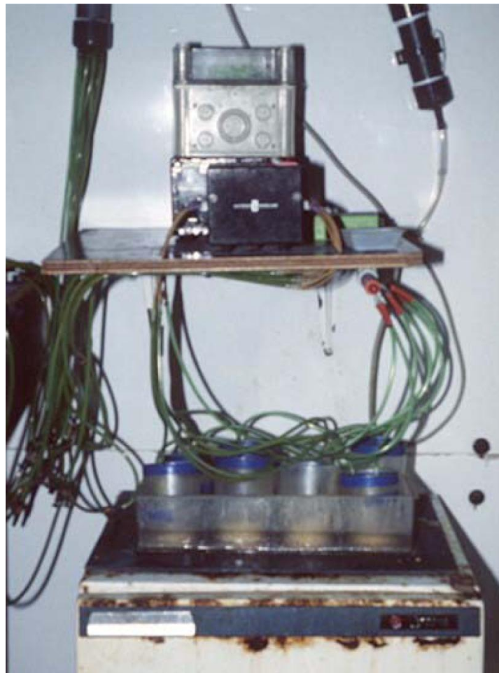
Εικ. 1.7. Ψύκτης αναστολής διανομής τροφής στις ατομικές δεξαμενές τροχόζωων με τη βοήθεια περισταλτικής αντλίας.
