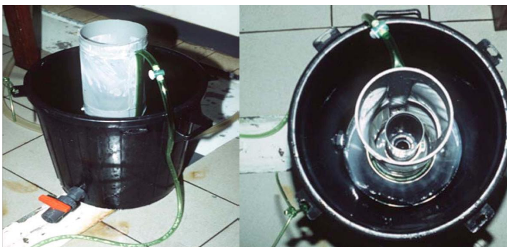
Εικ. 1.10. Πλάγια και κάθετη όψη συλλέκτη αποτελούμενο από φίλτρο με δίχτυ μεγέθους πόρων 50 \mu\text{m} εφοδιασμένου με κολάρο αερισμού στον πυθμένα του.
