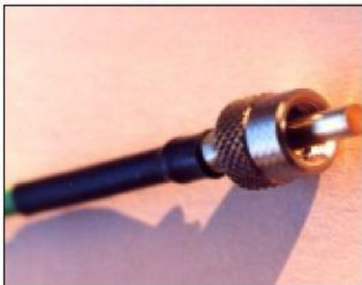
Εικόνα 13: LME connector, ένας από τους πρώτους connector για οπτικές ίνες
