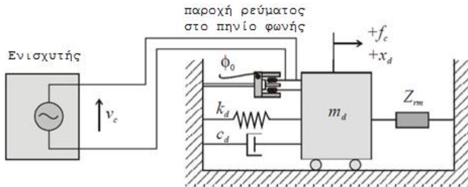
Σχήμα 4: Αναπαράσταση της μηχανικής συμπεριφοράς ενός ηλεκτροδυναμικού μεγαφώνου (Bright, 2002)
