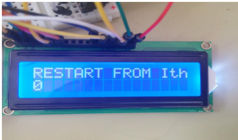
Εικόνα 59: Επιλογή μη αυτόματης επαναφοράς από θερμικό
