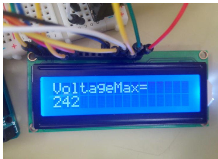
Εικόνα 50: Ορισμός μέγιστης τάσης στα 242Volt
