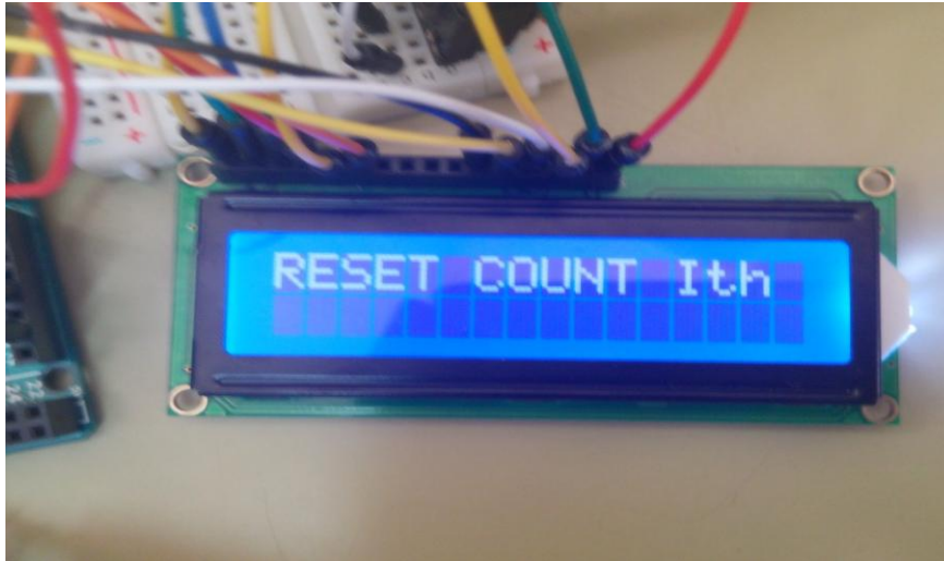
Εικόνα 61: Μηδενισμός του μετρητή σφαλμάτων από θερμικό
