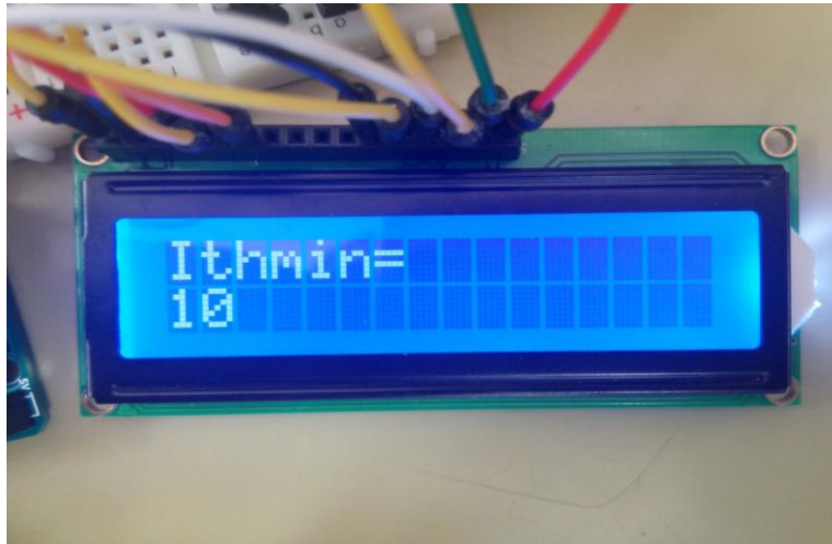
Εικόνα 53: Ρύθμιση της ελάχιστης επιτρεπόμενης τιμής του ρεύματος προστασίας στα 10 A
