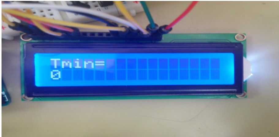
Εικόνα 55: Ρύθμιση της ελάχιστης επιτρεπόμενης τιμής του χρόνου εκκίνησης στα 0 sec
