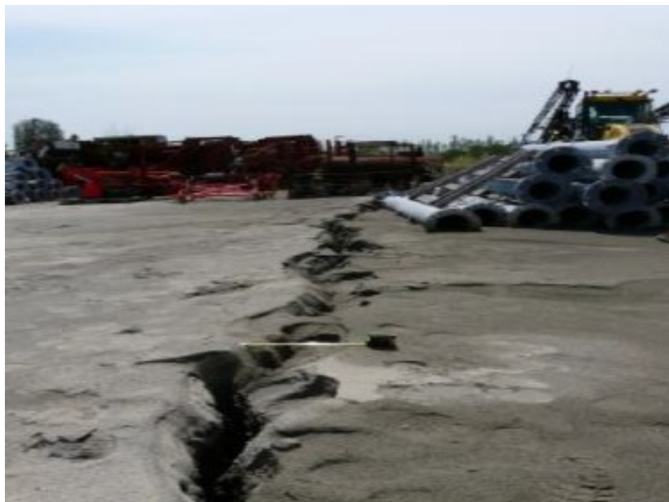
Εικόνα 1.4. Ανάδυση λεπτόκοκκου υλικού και άμμου με νερό – Δημιουργία κρατήρων/κώνων άμμου [11].
