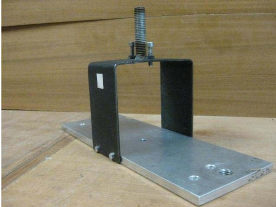
Εικόνα 1.7 Μεταλλική «θήκη» μέσα στην οποία εφαρμόζει ο επιταχυνσιογράφος με σκοπό να τοποθετηθεί σε συγκεκριμένη θέση πάνω σε πειραματικές διατάξεις. [16]
