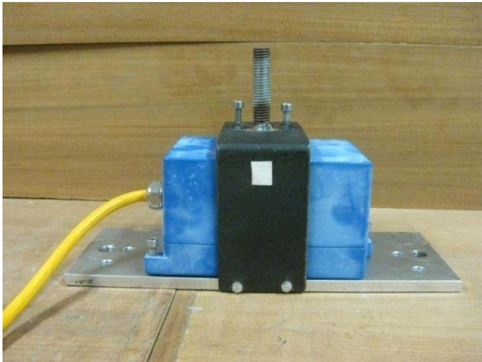
Εικόνα 1.8 Επιταχυνσιογράφος τοποθετημένος στη μεταλλική θήκη. Η σταθερότητα μεταξύ του επιταχυνσιογράφου και της μεταλλικής θήκης επιτυγχάνεται με κοχλίες.
