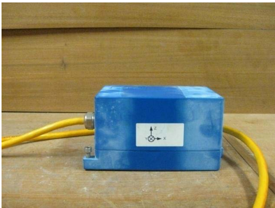
Εικόνα 1.5 Επιταχυνσιογράφος τύπου Geo-Sig AC-63. Διακρίνεται στη λευκή περιοχή, στο κέντρο του η αναπαράσταση της, προκαθορισμένης από τον κατασκευαστή διεύθυνσης των αξόνων .[13]
