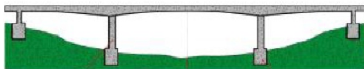
Σχήμα 1.6 – Γέφυρα σε δοκούς.
