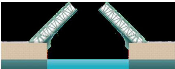
στ. Κινητή Γέφυρα
