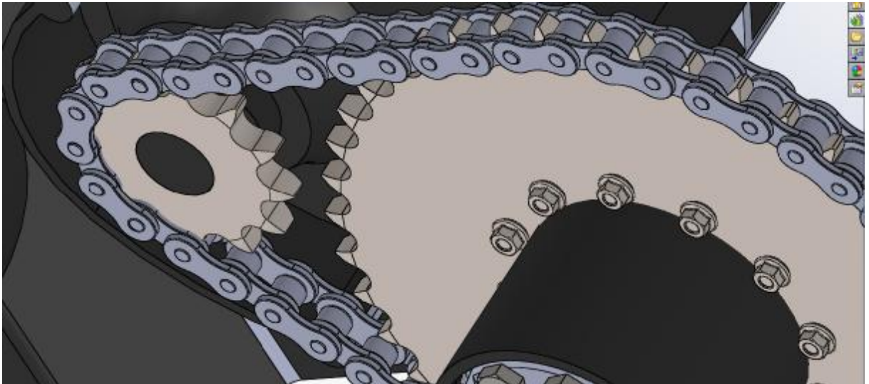
Σχήμα 5.17: Σύστημα μετάδοσης κίνησης
