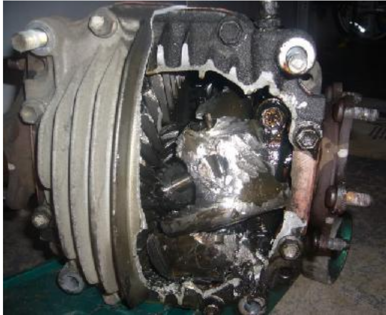
Σχήμα 3.9: Διαφορικό Torsen με βλάβη στα γρανάζια και στο κέλυφος (πηγή: www.google.gr )
