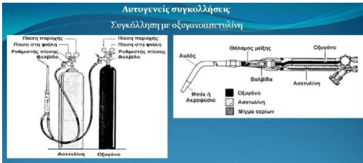
Σχήμα 3.4: Διάταξη συγκόλλησης με οξυγονοασετυλίνη ή οξυγονοσυγκόλληση.
