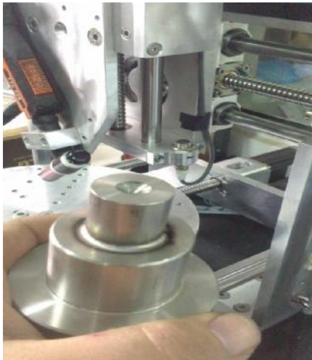
Εικόνα 5.1.4: Ραφή κυκλικής συγκόλλησης.
