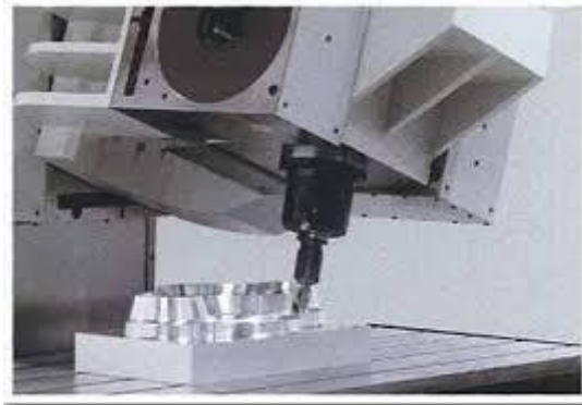
Σχήμα 2.1: Κατασκευή πολύπλοκου εξαρτήματος από εργαλειομηχανή CNC.
