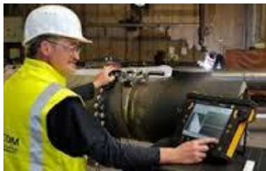
Σχήμα 3.3: Μη καταστροφικός Έλενος συγκόλλησης με υπέρυθρες ακτίνες.
