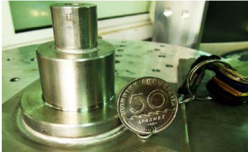
Εικόνα 5.1.: Ραφή κυκλικής συγκόλλησης πάνω σε πλακά ανοξείδωτη.
