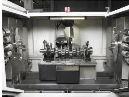
Σχήμα 2.3: Κέντρο κατεργασίας 12 αξόνων υψηλών προδιαγραφών με πολλαπλό εργαλειοφορέα
