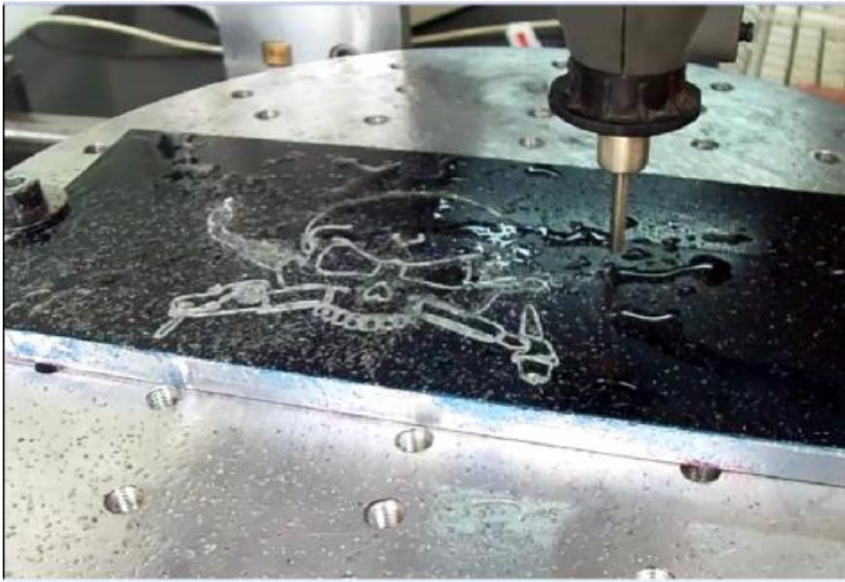
Εικόνα 5.2.1: Χάραξη σχεδίου σε πλακά αλουμινίου.
