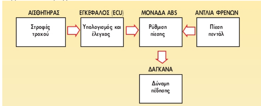
Σχήμα 3.5: Block διάγραμμα λειτουργίας ABS
